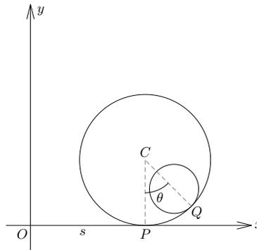
Sia  $C$  il centro dell'anello e  $Q$  il punto di contatto tra l'anello ed il disco. Usando come coordinate l'ascissa  $s$  di  $C$  e l'angolo  $\theta$  tra il segmento  $CQ$  e l'asse  $Oy$  (vedi figura),
