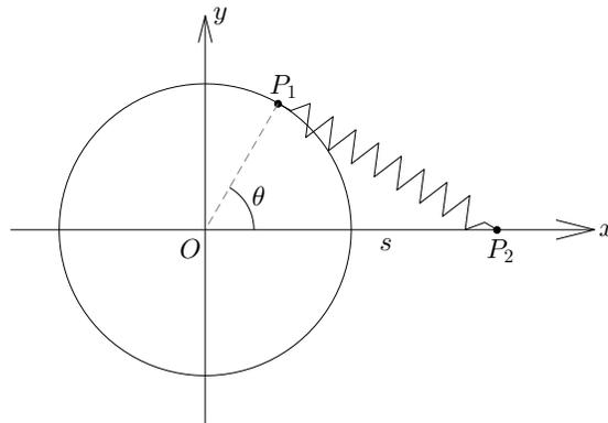
Per descrivere le configurazioni del sistema si usi l'angolo  $\theta$  formato dal segmento  $OP_1$  con l'asse  $Ox$  e l'ascissa  $s$  del punto  $P_2$  (vedi figura).
