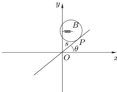
Usando come coordinate l'angolo  $\theta$  che l'asta forma con l'asse  $Ox$  e l'ascissa  $s$  sull'asta del punto di contatto  $P$  tra disco e asta
