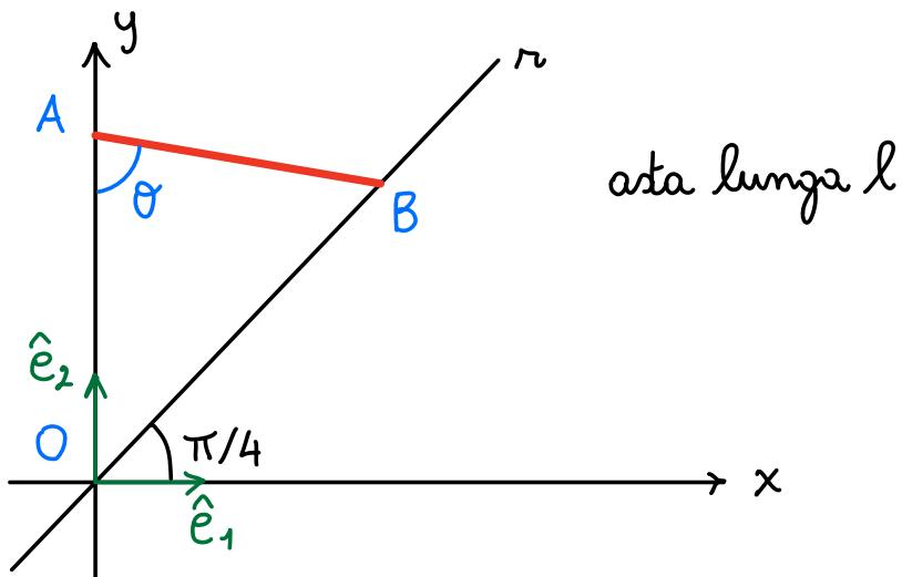
l'istruzione A dell'asta può scivolare lungo l'asse Oy, l'istruzione B dell'asta può scivolare lungo la retta r
