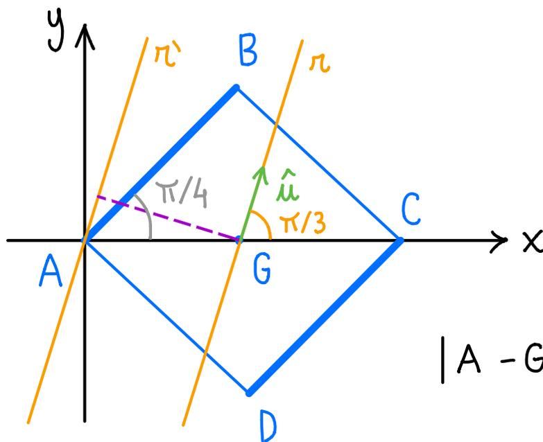
ii) Trovare il momento d'inerzia del corpo rispetto ad una retta passante per il suo baricentro e inclinata di  $\pi/3$  rispetto all'asse  $Ax$
