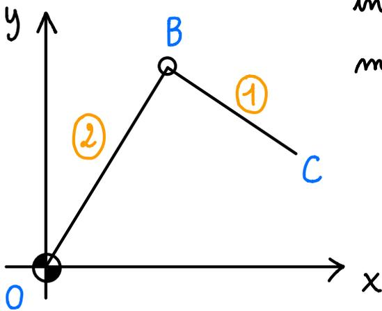
in B c'è una coppia rotoidale mobile, e in O una coppia rotoidale fissa
