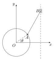
Sia  $\theta$  l'angolo tra il segmento OA e l'asse Ox. Assumiamo che  $\theta \in (-\frac{\pi}{2}, \frac{\pi}{2})$  (quando  $\theta < 0$  l'ordinata di A è negativa) e che la configurazione del sistema ad un certo istante sia quella mostrata in figura. Usando come variabile  $\theta$ ,
