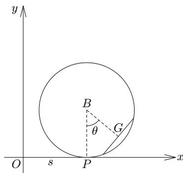
Siano  $B$  e  $G$  i baricentri dell'anello e dell'asta. Usando come coordinate l'ascissa  $s$  del punto  $B$  e l'angolo  $\theta$  tra il segmento  $BG$  e la direzione verticale (vedi figura),
