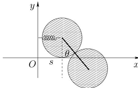
I due dischi rotolano senza strisciare l'uno sull'altro ed il disco  $\mathcal{D}_1$  rotola senza strisciare sull'asse  $Ox$ . Una molla di costante elastica  $k$  collega il baricentro  $B_1$  del disco  $\mathcal{D}_1$  all'asse  $Oy$ , mantenendosi sempre orizzontale.
