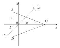
L'asse r divide l'asse di simmetria CD del triangolo in due parti, di lunghezza a, c rispettivamente (h = a + c). Dimostrare che, scelti a, b con  $b^2 > 12a^2$ , è possibile determinare c in modo da ottenere la rotazione uniforme del triangolo con momento delle forze esterne nullo rispetto al polo O.
